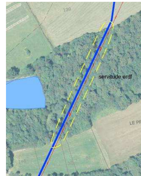
Figure 148 : Localisation de la zone de servitude au sein de l'EBC sur Reinais (la ligne bleue correspond au tracé de la canalisation)
